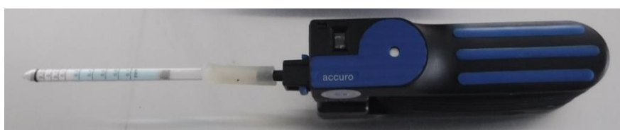
Abbildung 8: Dräger-Pumpe mit Prüfröhrchen zur Ozonmessung.
